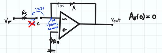
• pole at:  $f_p = \frac{1}{2\pi R_{eq} C} = \frac{1}{2\pi R_s C}$
