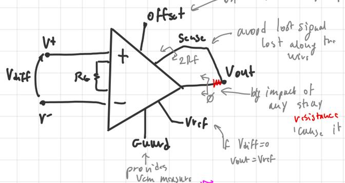
$$V_{out} = G_{INA} \cdot V_{diff} + V_{ref}$$
