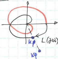
Se  $K > 1$  sposta il pto del diagramma lungo il raggio
